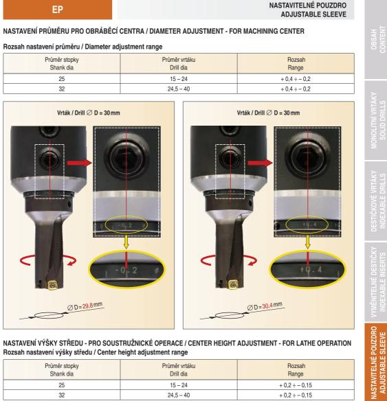
NASTAVENÍ VÝŠKY STŘEDU - PRO SOUSTRUŽNICKÉ OPERACE / CENTER HEIGHT ADJUSTMENT - FOR LATHE OPERATION Rozsah nastavení výšky středu / Center height adjustment range
